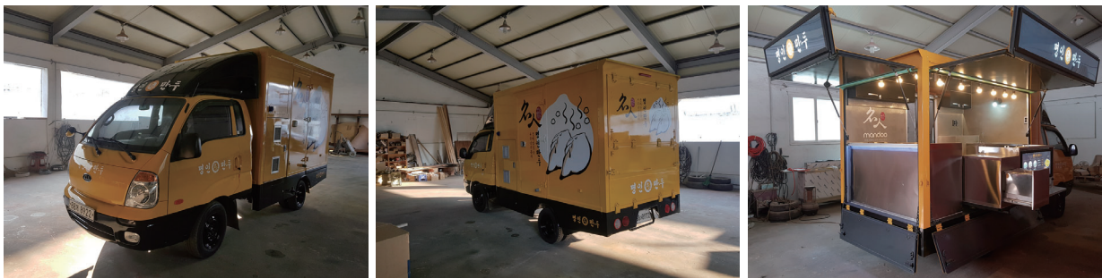
수요처 : 명인만두 사양 : 1톤 쇼바탑 제작 차량구조변경 차량광고 도색 및 랩핑(내부 시설)
